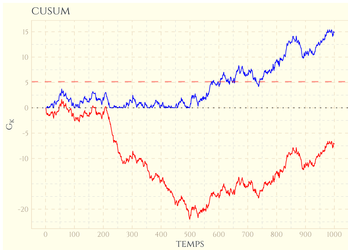
FIGURE 3.6 – Le processus séquentiel du logarithme des rapports de vraisemblance (LPSR) S_k en rouge et le processus CUSUM S_k - m_k en bleu
