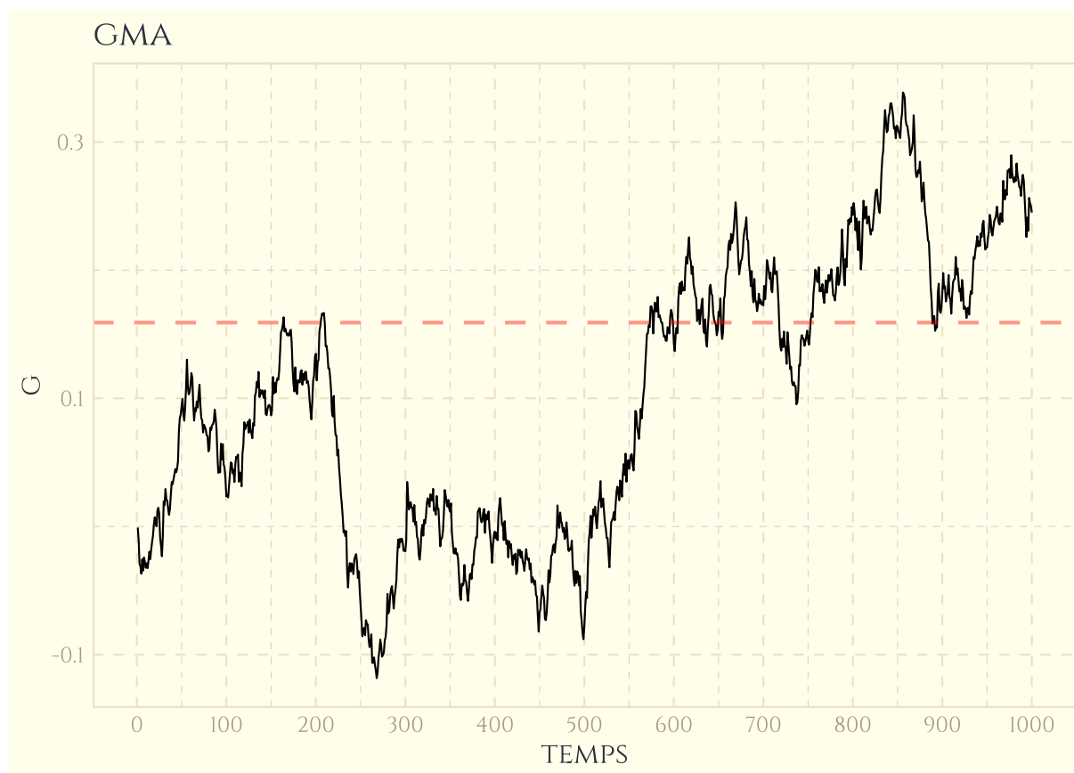
FIGURE 3.3 – Carte de contrôle à moyenne mobile géométrique
